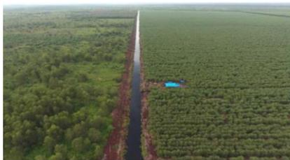
KANAL MILIK PT. SERAYA SUMBER LESTARI DENGAN LEBAR LEBIH DARI 15 M. KANAL INI DIGUNAKAN UNTUK TRANSPORTASI PEKERJA DAN TRANSPORTASI PANEN KAYU AKASIA. GAMBAR DIAMBIL DENGAN DRONE PADA 04/11/2016 DENGAN KORDINAT N 00;55;09.42 E 101; 51; 20.46
